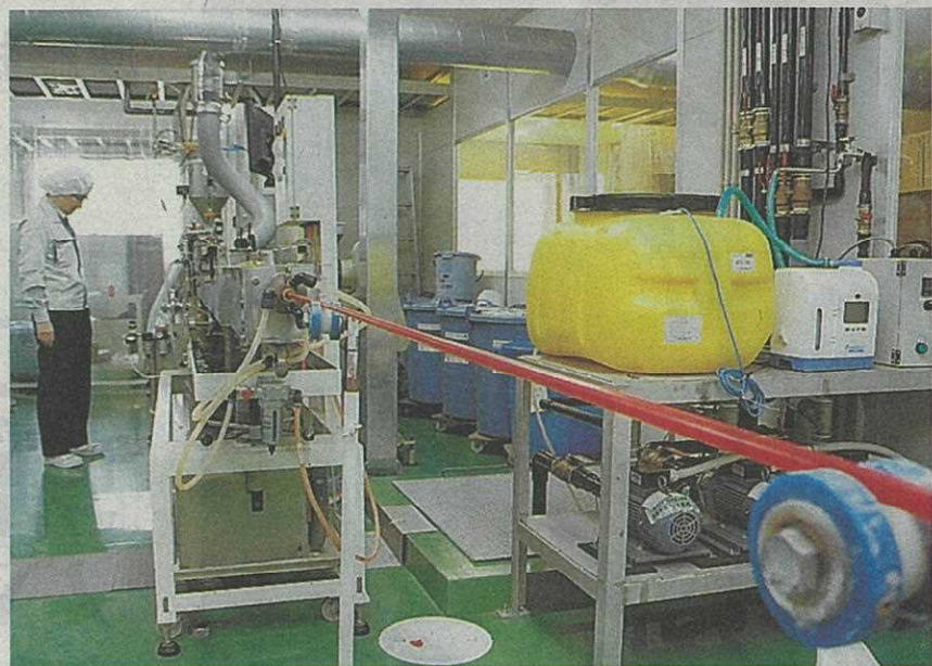
シバセ工業の工場。樹脂の粒を溶かして管状に伸ばし、水で冷やして固める=10月10日、岡山県浅口市
