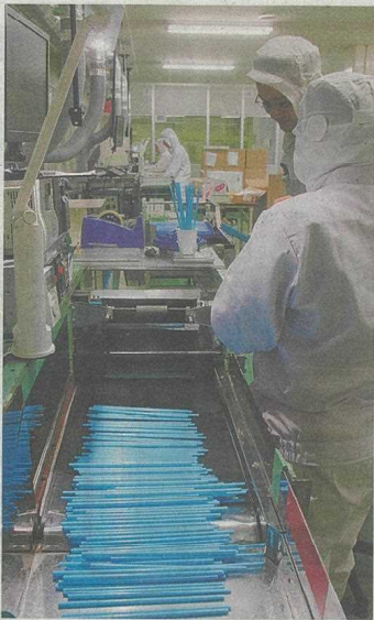
カッターで切断してストローの原型の出来上がり。蛇腹加工や医療・工業用の特殊加工を施し、出荷する。
