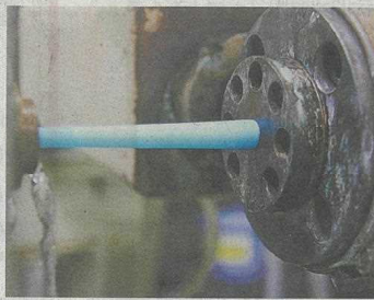
原料を高温で溶かし、金型(右)から押し出す。左の水槽に通し、冷やしながらか、形を整えていく。
